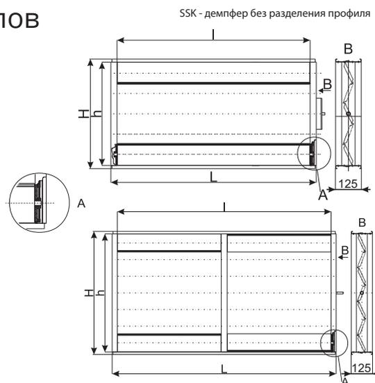
Заслонки для SSK для регулировки воздушного потока. Заслонки изготовлены из алюминиевых профилей с резиновым уплотнителем. Управляющий механизм лопаток изготовлен из стекловолокна. Уплотнительный материал обеспечивает необходимую герметичность заслонок. Заслонки пригодны к эксплуатации в температурном диапазоне от  $-40^{\circ}\text{C}$  до  $+80^{\circ}\text{C}$ . Так как фланцевая система этих заслонок такая же, как в прямоугольных воздуховодах или вентиляторах, она легко монтируется.
